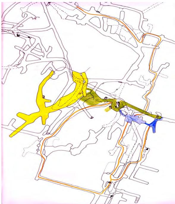
**Fig. 4** - Tratti di gallerie oggetto del progetto originario di messa in sicurezza. In giallo: Livello Bice. In verde: Livello Henfrey. In blu: Livello Intermedio basso. Linea arancione: galleria ispezionabile.
