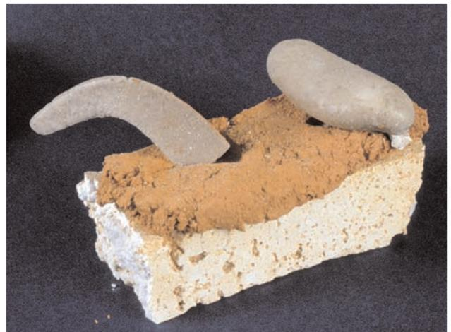
*Fig. 12* - I coni di Seger (mostrati nella figura precedente) dopo la cottura: a sinistra quello di 835°C, a destra quello di 780°C.
