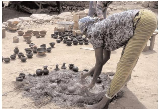
**Fig. 16** - Focolare aperto per la cottura di ceramica.
