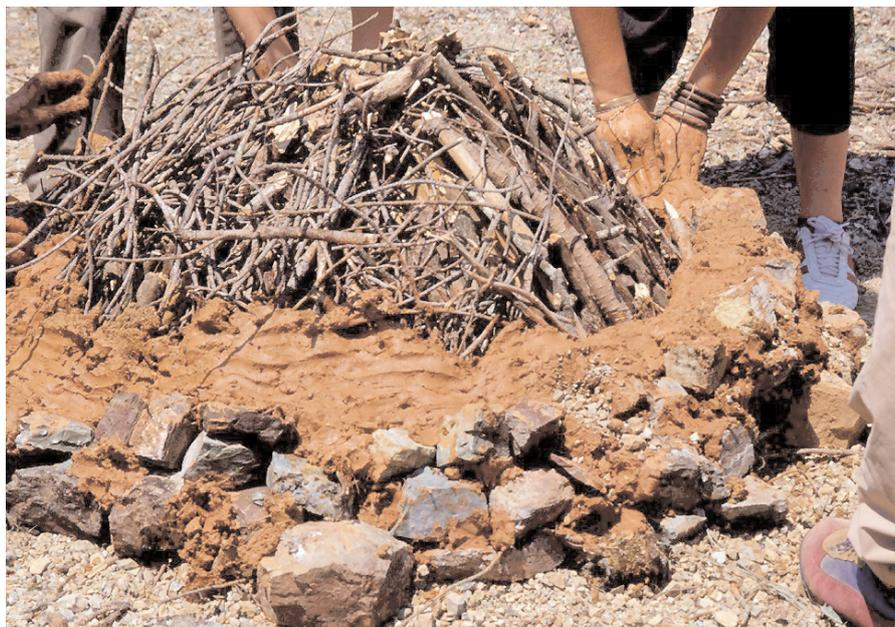
Fig. 4 - Coibentazione della catasta con un manto di argilla.
