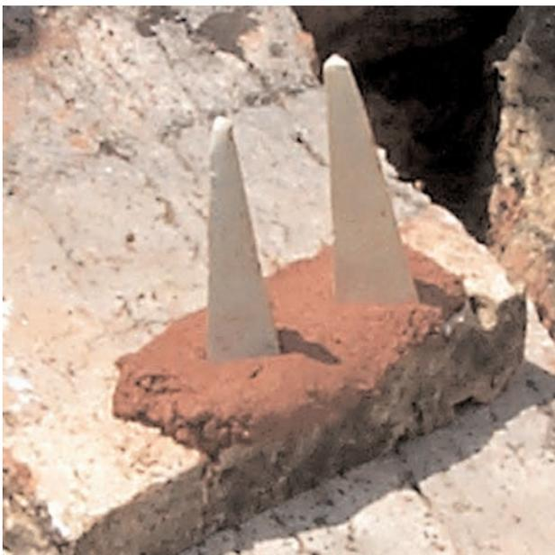
*Fig. 11* - Coni di Seger crudi: posizionamento con inclinazione di 8°.
