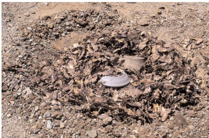
Fig. 2 - Fornace a catasta: caricamento dei crudi in una fossa colmata di fogliame.
