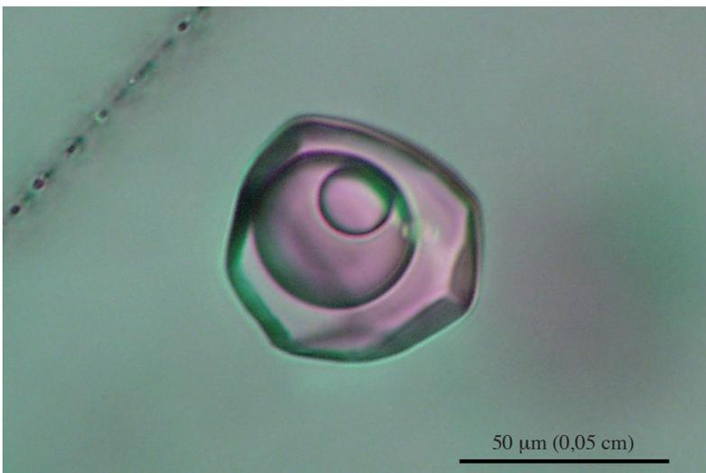
**Fig. 7** - Inclusione fluida in un cristallo di quarzo. L'inclusione consiste di anidride carbonica in vapore e di anidride carbonica liquida (in grigio), contenute all'interno di acqua (trasparente).
